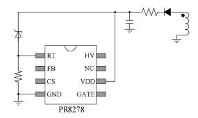
$$V_{\text{th OVP}} = V_{\text{zener}} + 4V$$
